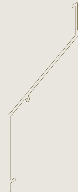
L.150.DAC.01 Lame adaptée à un système acoustique
